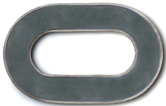
Längsschnitt durch ein einsatzgehärtetes Kettenglied
