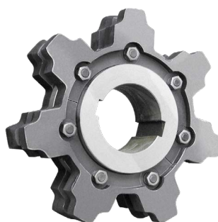
HEKO Kettenrad Typ GTA, taschenverzahnt, austauschbar, Nabe in geschweißter Ausführung
