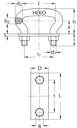
MBK = Mindestbruchkraft, t = Teilung, d = Durchmesser. Bei verzahnten Kettenrädern muss die Teilung der Kettenbügel gleich der Teilung der Ketten sein, bei unverzahnten Kettenrädern sollte die Bügelteilung eine Abmessung größer sein. Weitere Qualitäten auf Anfrage.
