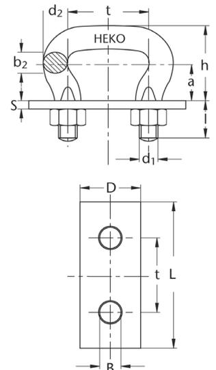
MBK = Mindestbruchkraft, t = Teilung, d = Durchmesser. Bei verzahnten Kettenrädern muss die Teilung der Kettenbügel gleich der Teilung der Ketten sein, bei unverzahnten Kettenrädern sollte die Bügelteilung eine Abmessung größer sein. Weitere Qualitäten auf Anfrage.
